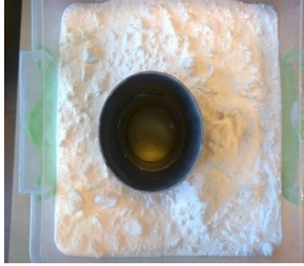
Şekil 4.21 : Nötron zırhlamasında kullanılan borik asit ile oluşturulan zırh ve kolimasyon sistemi.
