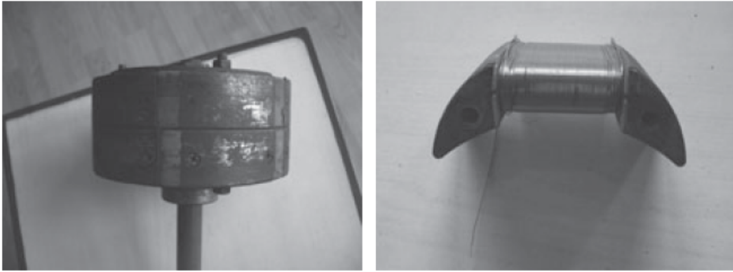
Şekil 2.12 : Basit sabit mıknatıslı jeneratör (SMJ). Sol: rotor. Sağ: üç stator sargısından biri.
