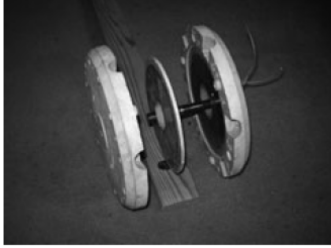
Şekil 2.13 : Sabit mıknatıslı rotorlarla bir Rutland 910 türbin arasından demirsiz stator.
