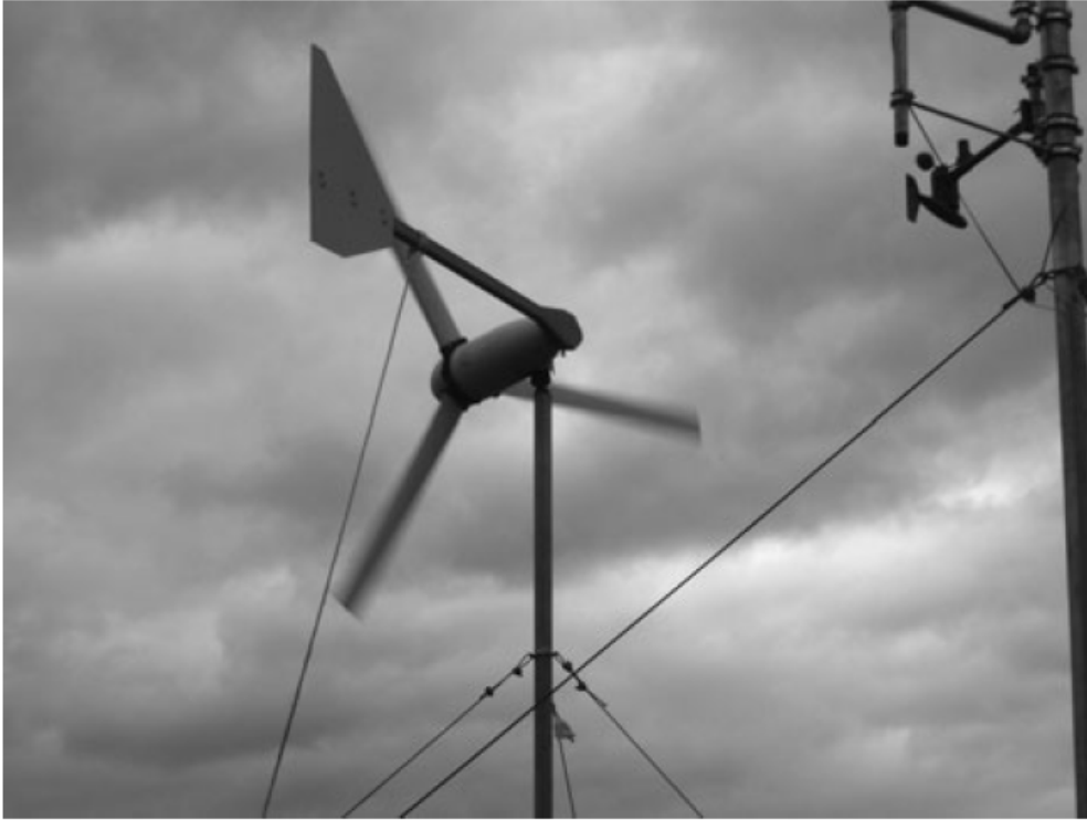
Şekil 2.14 : Rüzgar türbini tamamen rüzgardan kaçınır ancak rüzgar yönü değiştiğinden dönmeye devam eder.
