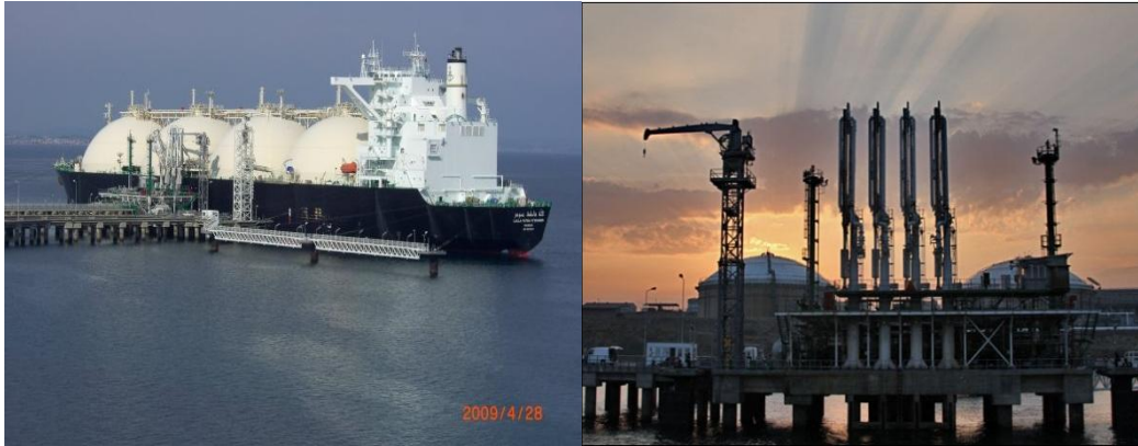
Şekil 3.12: Operasyon için hazır bir gemiden genel görünüş - 3 adet sıvı, 1 adet gaz kolu (Url-10)
