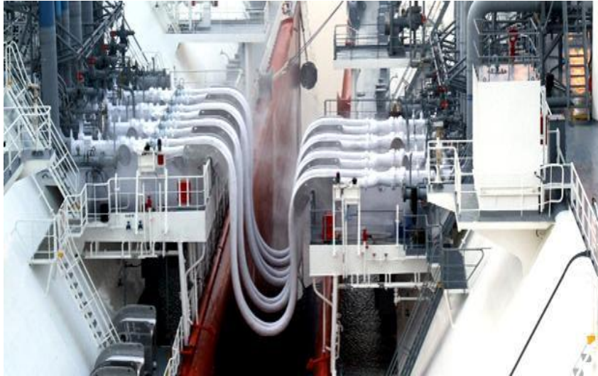
Şekil 5.4: Esnek kriyojenik hortumlar ile LNG transferi (IGU,2011)
