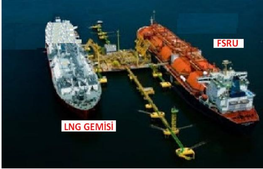
Şekil 5.3: İskele üzerinden LNG transferi (Golar LNG Report,2011)
