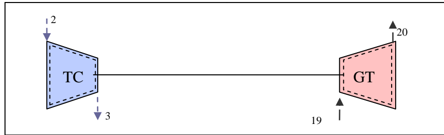
Şekil 3.8: Turbo kompresörü ve gaz türbini kontrol hacmi
