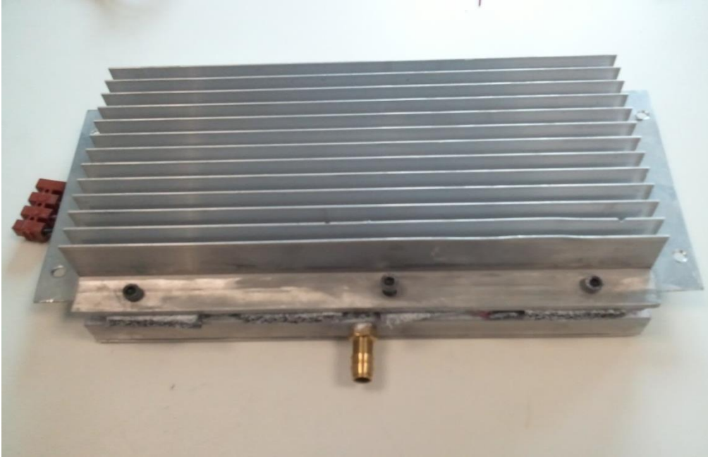
Şekil 3.3 : Hava-su soğutmalı termoelektrik soğutma sistemi
