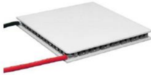
Şekil 2.9 : TE modülün genel görünümü
