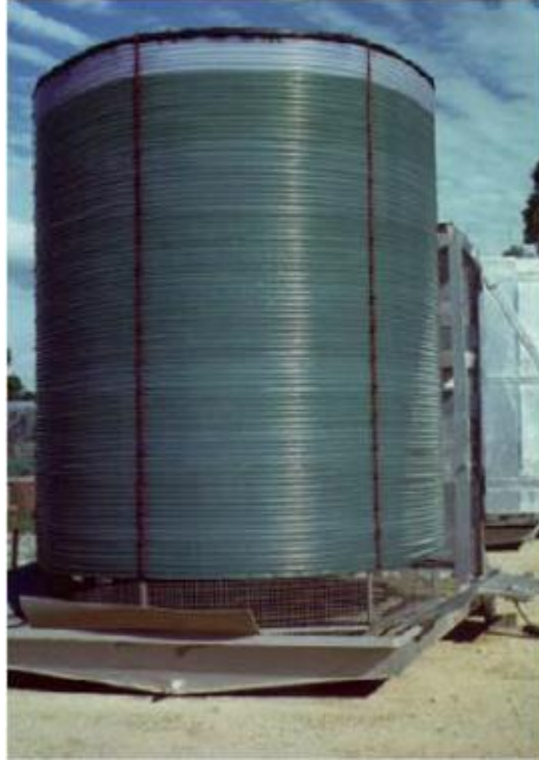
Şekil 2.11 : 1.000 litrelik sarmal tp Őeklindeki fotobiyoreaktr (Murdoch niversitesi, Avustralya) [2].
