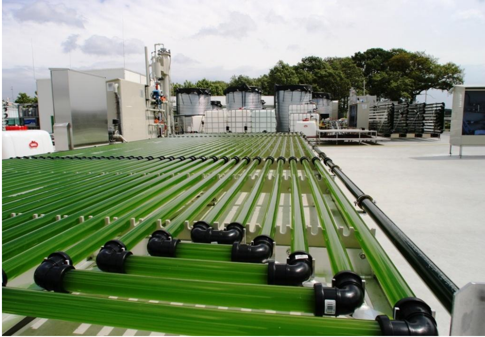
Şekil 2.10 : Yatay konumlu tüp şeklinde fotobiyoreaktör, AlgaePARC [28].
