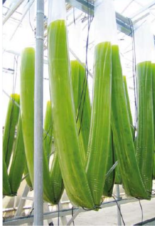
Şekil 1.5 : Niederaussem mikroalg yetiştirme tesisinde kullanılan fotobiyoreaktörler [11].
