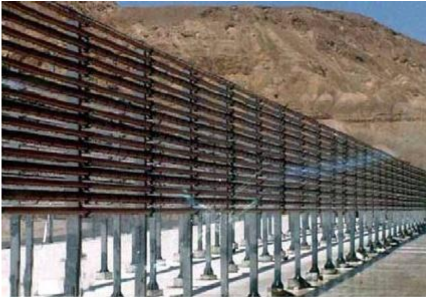
Şekil 2.8 : Dikey konumlu tüp şeklindeki fotobiyoreaktör ( Haematococcus pluvialis üretimi, 100 metre uzunluk 5 cm çap, AlgaTech. Co., İsrail) [20].
