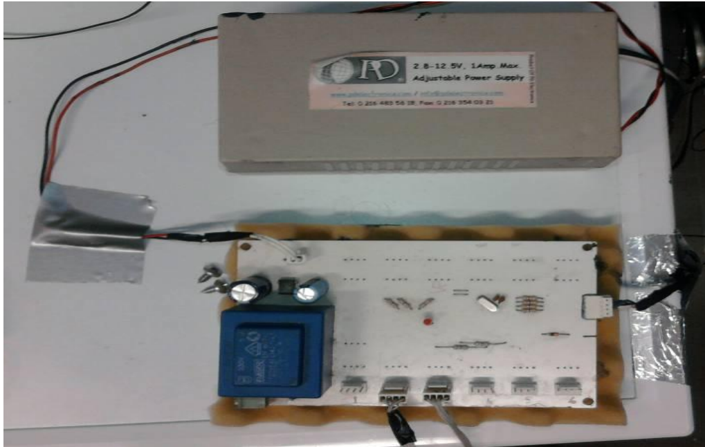
Şekil 4.2 : Elektronik nem sensörü kartı
