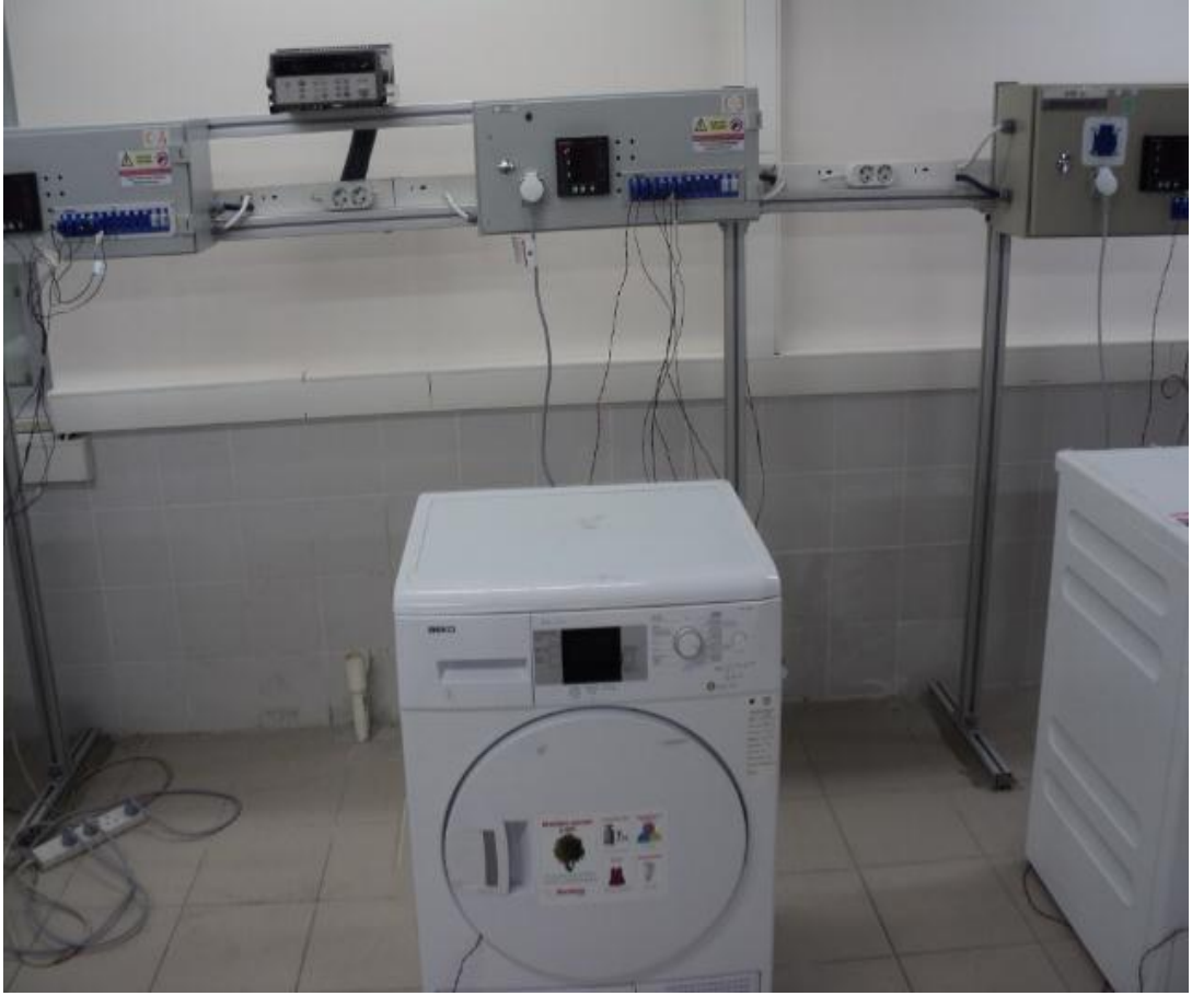
Şekil 4.5 : Güç ve Sıcaklık Ölçümündeki Bir Makine
