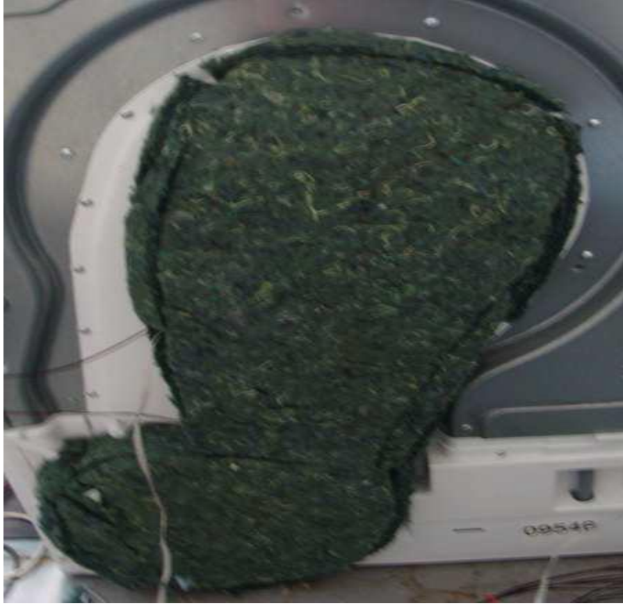
Şekil 5.19 : Arka Duvarı Yalıtılmış Prototip Kurutucu
