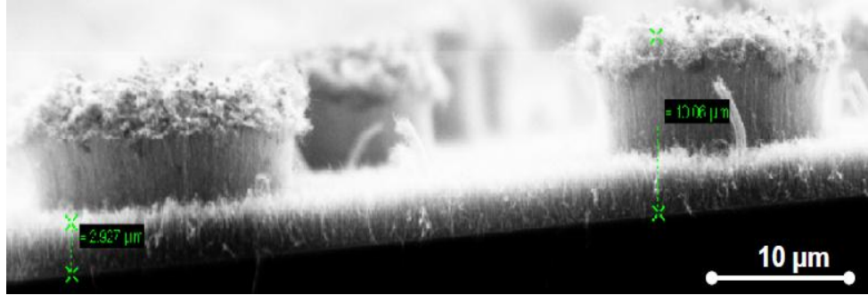
Şekil 6.26 : Al/Fe(2)/Al/Co numunesinin çeşitli büyütme oranlarındaki SEM görüntüleri (200 °C’de 30 dk oksidasyon).
