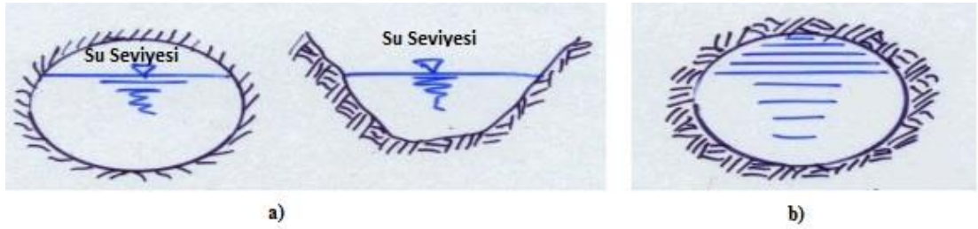
Şekil 3.3 : Akım tipleri; a) Serbest yüzeyli akım b) Basınçlı akım (Önöz, 2011)
