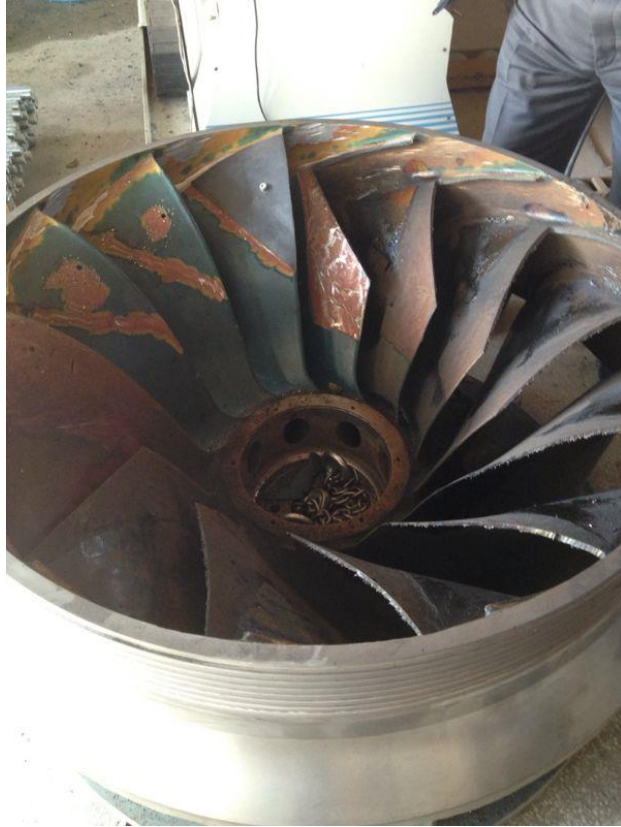
Şekil 6.42: Zarar gören türbin çarkları
