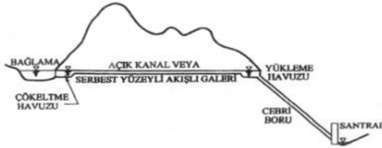
Şekil 3.4 : Biriktirmesiz hidroelektrik santral kesiti (nz, 2009)
