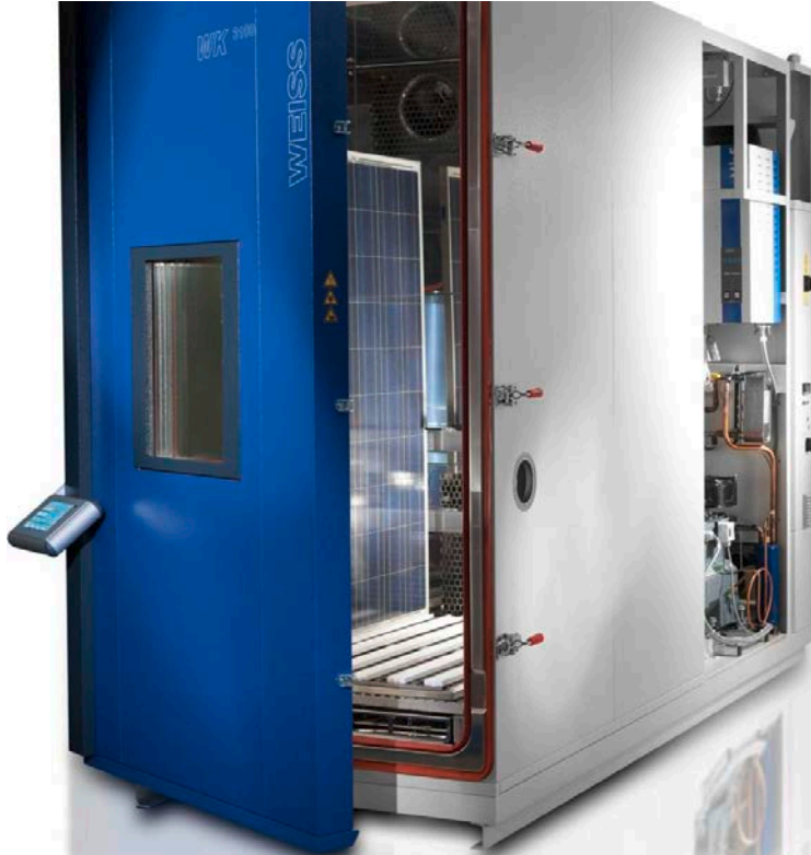
Şekil 6.6 : Laboratuvarda kullanılan nem-buzlanma testi için iklimlendirme kabini
