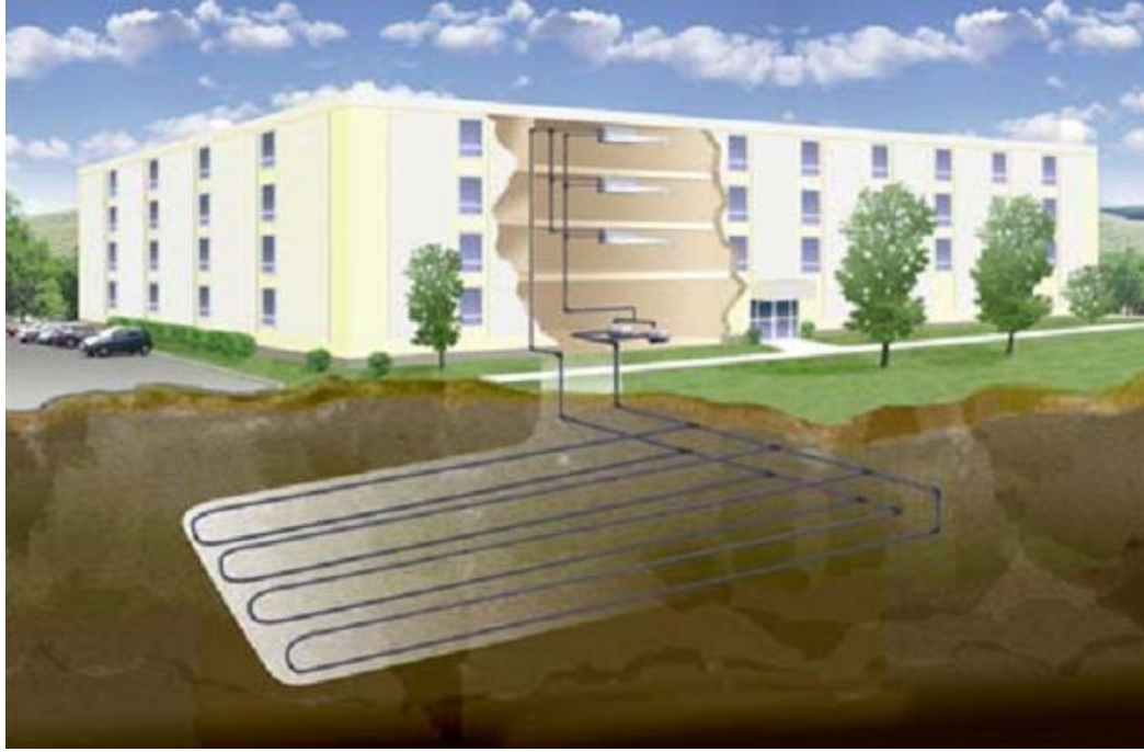
Şekil 2.15 : Yatay boru uygulamaları (McQuay Airconditioning, 2002).
