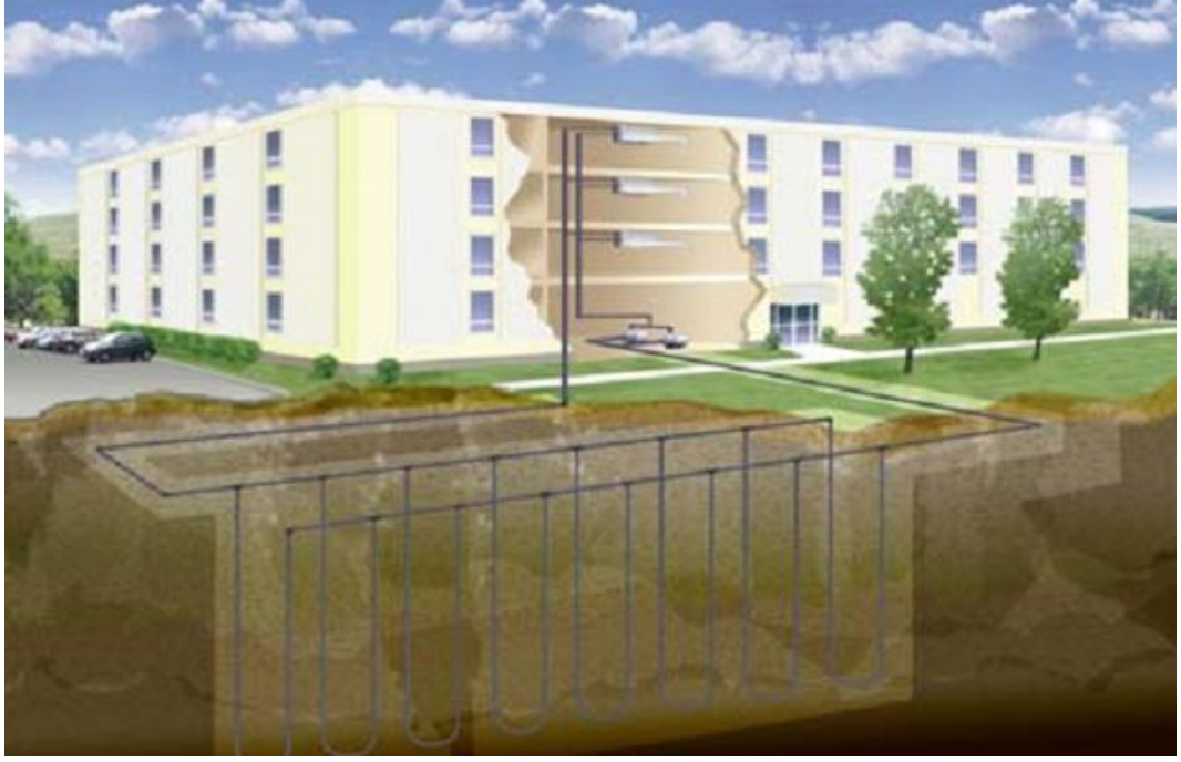
Şekil 2.16 : Düşey sondaj uygulamaları (McQuay Airconditioning, 2002).
