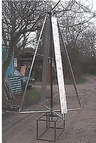
Şekil 2.16 : \Delta -Darrieus türbini [3].
