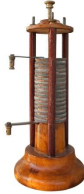
Şekil 2.1 : Tarihte kullanılan ilk Volta pili [Url-1].
