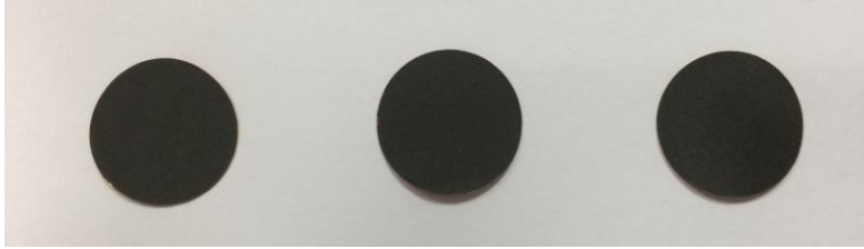
Şekil 4.5 : Düğme pil boyutunda kesilen numuneler
