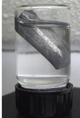
Şekil 2.5 : Kolay oksitlenen lityum metalinin mineral yağ içinde depolanması [13].
