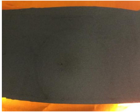
Şekil 4.4 : Anot malzemesi ile kaplanmış bakır folyo.
