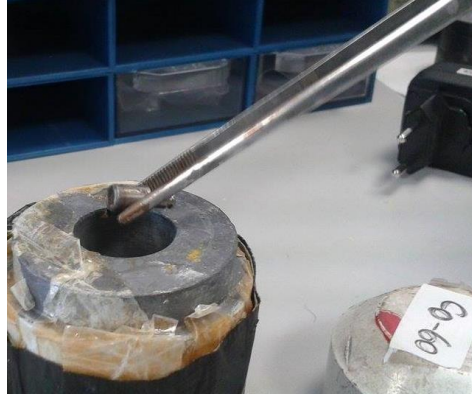
Şekil 5.2 : Gama geçirgenlik düzeneğinde kullanılan Co-60 radyoizotopu.
