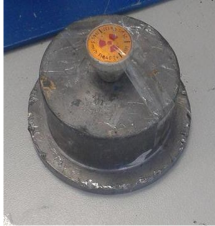
Şekil 5.3 : Gama geçirgenlik düzeneğinde kullanılan Cs-137 radyoizotopu.
