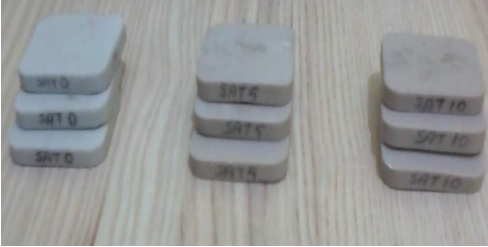
Şekil 4.1: Alüminyum titanat katkılı spinel kompozit malzemeler.
