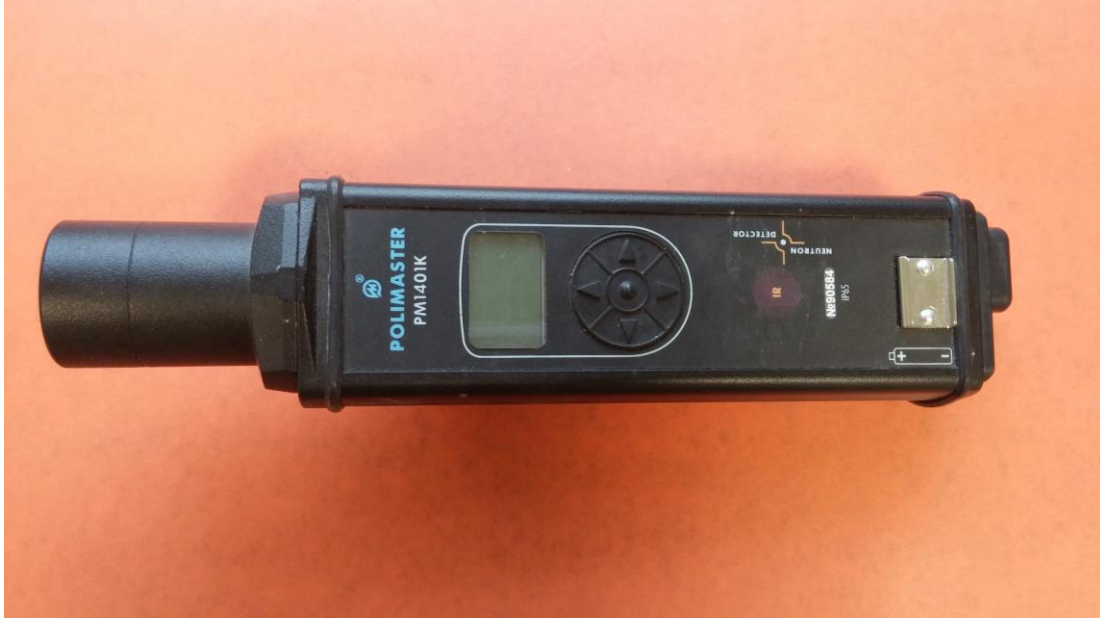
Şekil 4.10 Nötron ölçümlerinde kullanılan dedektör.
