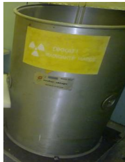
Şekil 4.9 Deneylerde kullanılan Pu-Be nötron kaynağı (Hovitzer).
