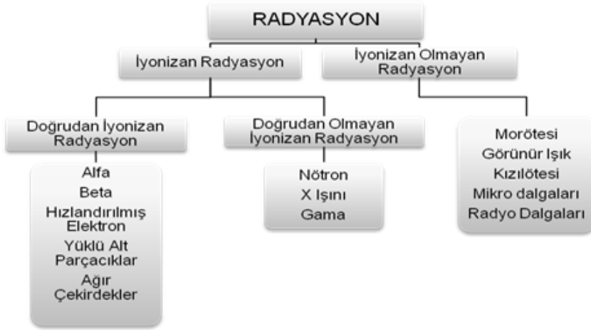
Şekil 2.1 Radyasyonun enerjisine göre sınıflandırılması (Tuğrul, 2012).
