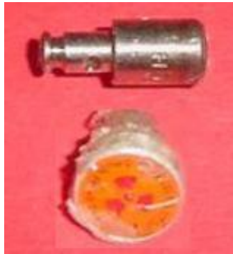
Şekil 4.5 Deneylerde kullanılan ^{137}\text{Cs} ve ^{60}\text{Co} radyoizotopları.
