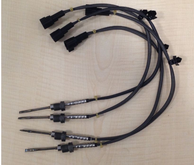
Şekil 3.3 Testte kullanılan sıcaklık sensörleri.
