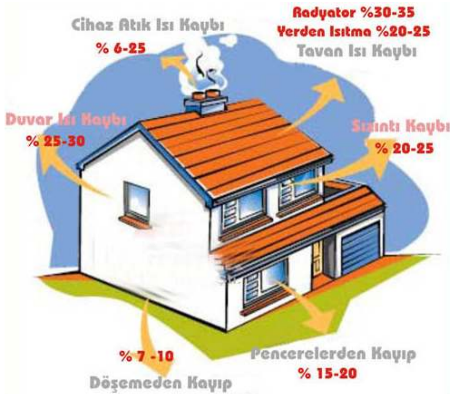
Şekil 5.1 : Binalarda ısı kayıpları [45].
