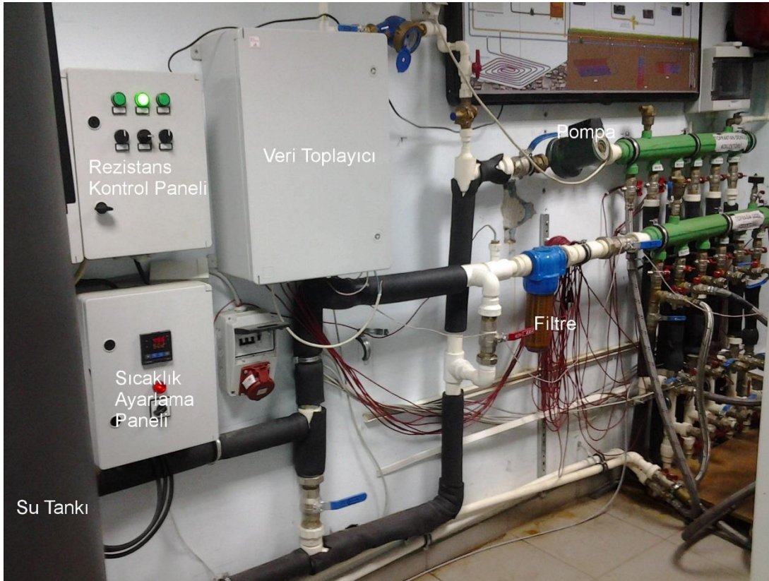
Şekil 2.7 : Isıl tepki test sistemi görüntüsü.
