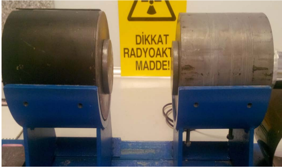
Şekil 3.5 : Dar demet geometrisini sağlayan kolimatörlerin görünümü.
