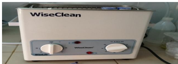
Şekil 5.8: Altlıkların temizleme işleminde kullanılan ultrasonik banyo cihazı
