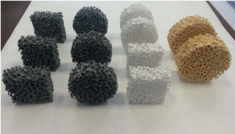
Şekil 3.6: Silisyum karbür (gri renkli), alümina (beyaz renkli) ve magnezyum (sarı renkli) metalik köpük malzemeler.
