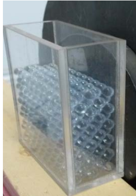
Şekil 3.8. Pleksiglas kap içerisinde düzgün yerleştirilmiş cam bilyelerden oluşan gözenekli ortam.
