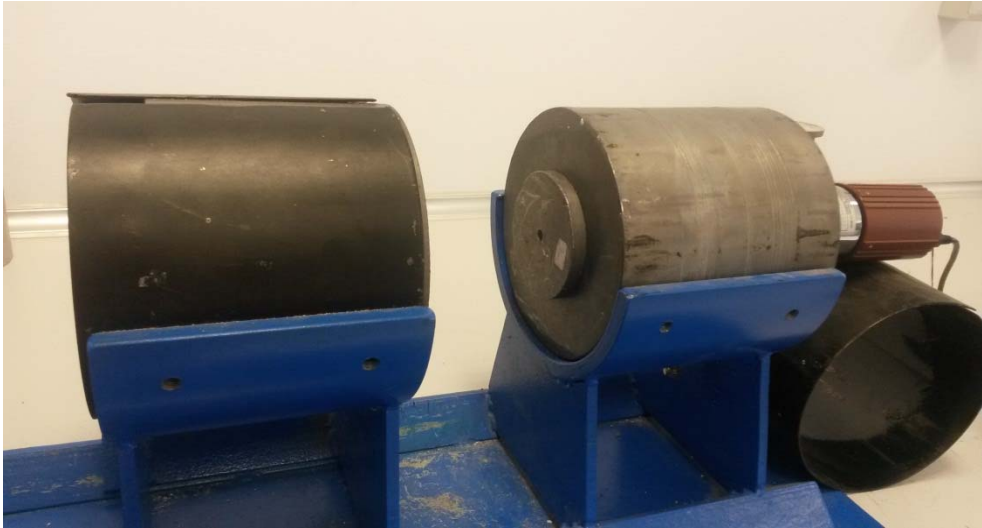
Şekil 3.5: Dar demet geometrisini sağlayan kolimatörlerin görünümü.
