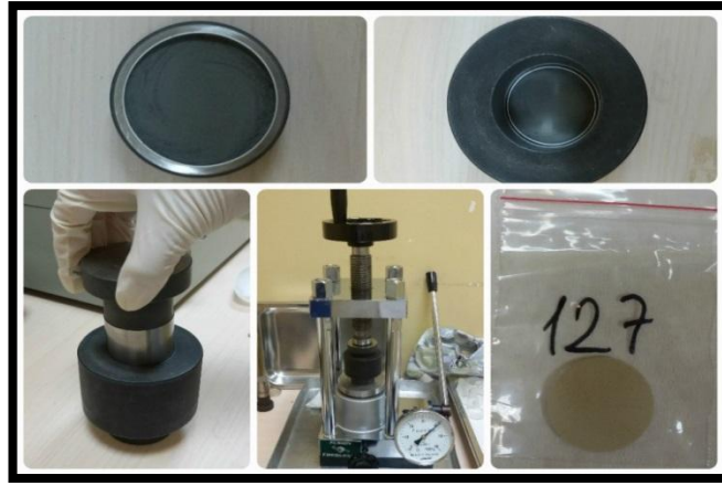
Şekil 3.7 : Örneklerin peletlenme işlemleri.
