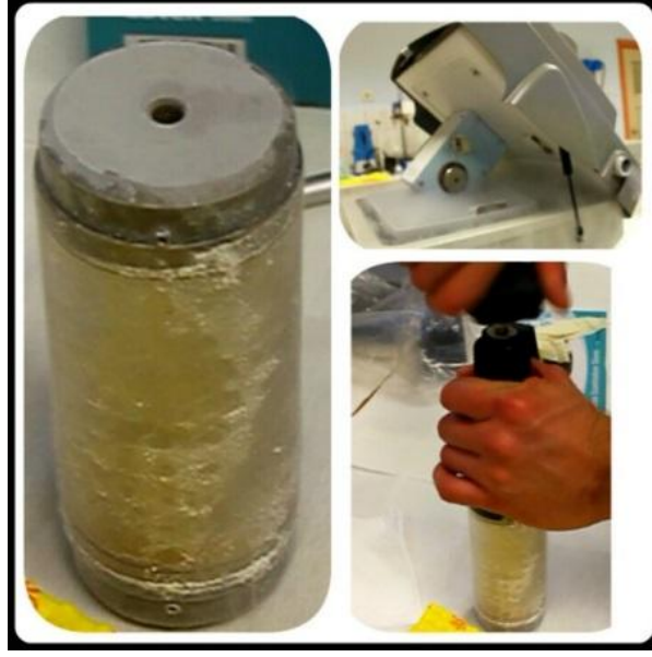
Şekil 3.5: Donduruculu öğütücüde örneklerin işlenmesi.
