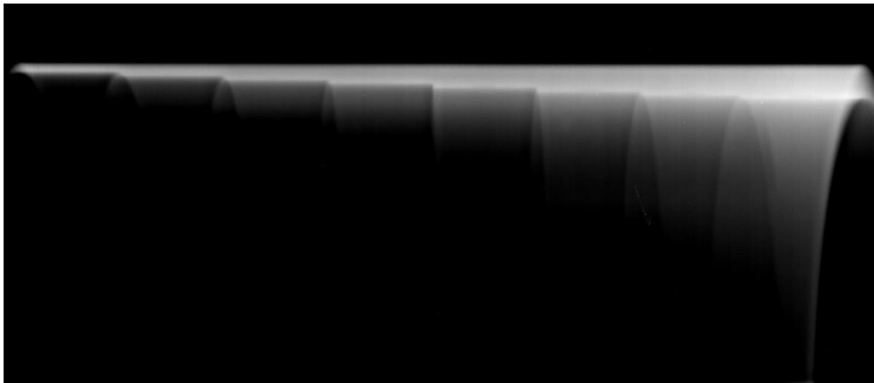
Şekil 6.1 : % 10 cidar kaybı olan örneklerin dijital radyografi sisteminde, 66 dakikada elde edilen radyografik görüntüsü.
