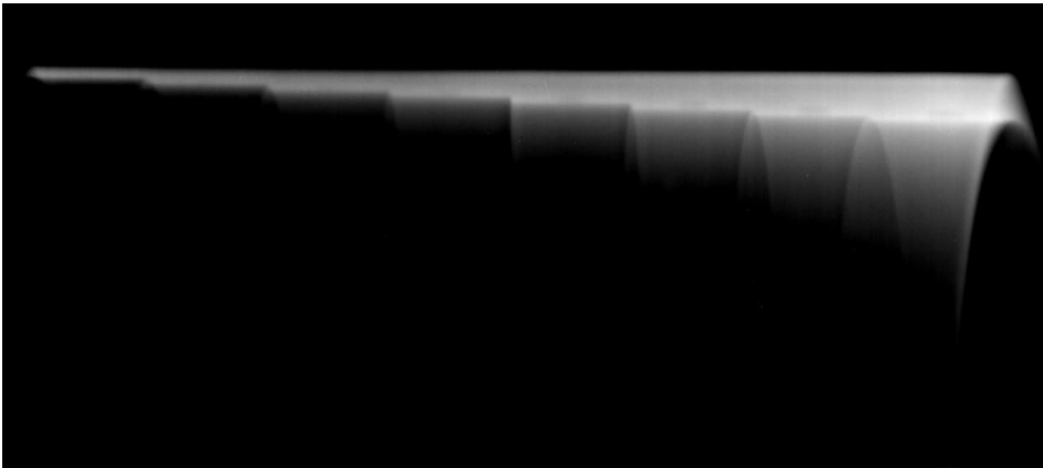
Şekil 6.3 : %20 cidar kaybı olan örneklerin dijital radyografi sisteminde, 66 dakikada elde edilen radyografik görüntüsü.
