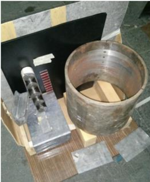
Şekil 5.9 : Radyografik çekimlere ait değişik açılardan çekim düzeneği.
