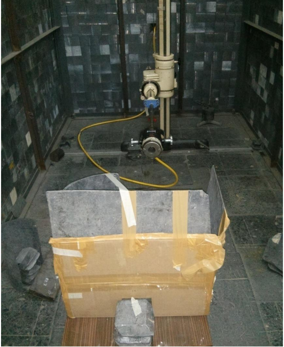
Şekil 5.6 : Radyografik çekimlere ait ışınlama düzeneği.
