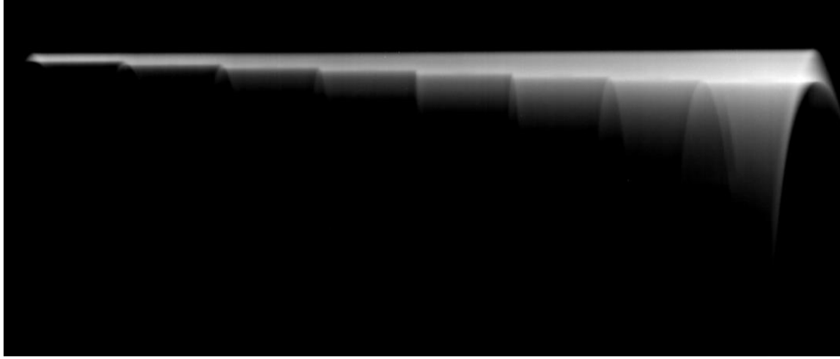
Şekil 6.2 : %10 cidar kaybı olan örneklerin dijital radyografi sisteminde, 72 dakikada elde edilen radyografik görüntüsü.
