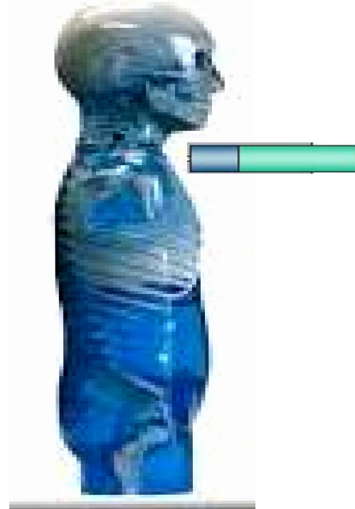
Şekil 4.12: Tiroit için doz hızı ölçümüne ilişkin pozisyonlama.
