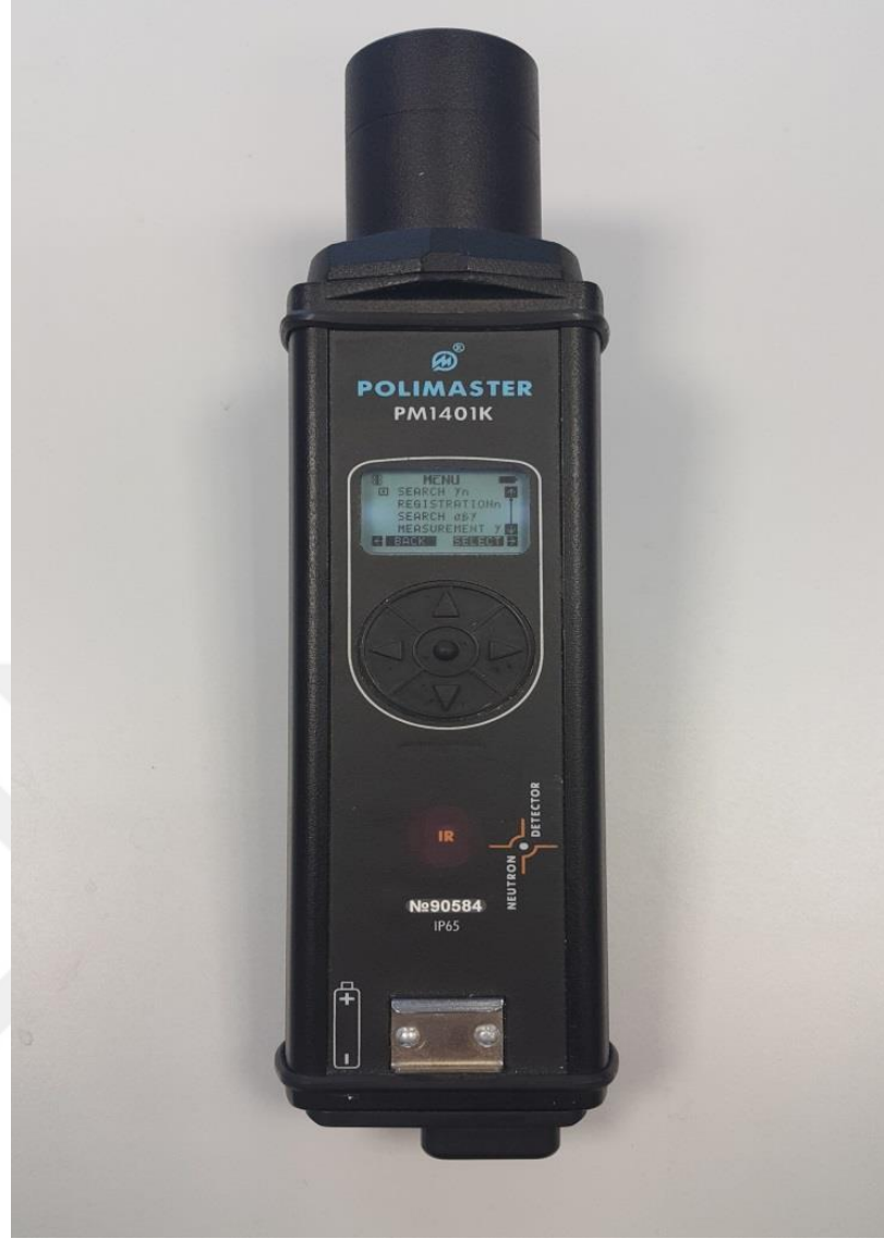
Şekil 4.7: PM1401K polimaster dedektörün görüntüsü.
