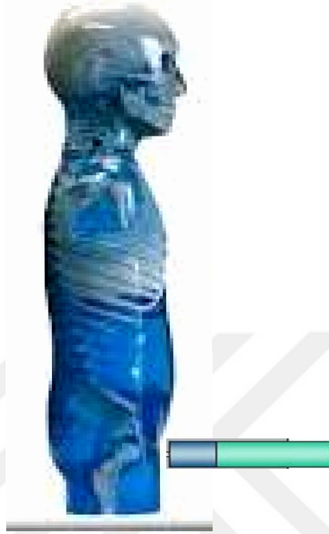
Şekil 4.11: Gonad için doz hızı ölçümüne ilişkin pozisyonlama.
