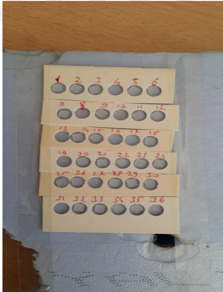
Şekil 4.19: TLD kristillarenin görüntüsü.
