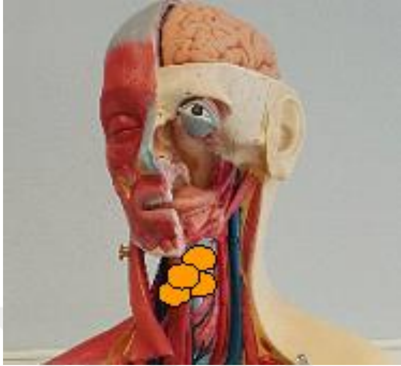
Şekil 4.15: Tiroite yerleştirilen TLD'lerin pozisyonlaması.
