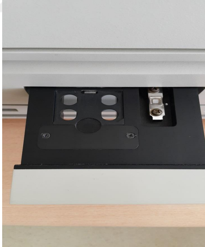
Şekil 4.23: TLD okuyucusunda TLD kristalinin yerleştirildiği bölge.
