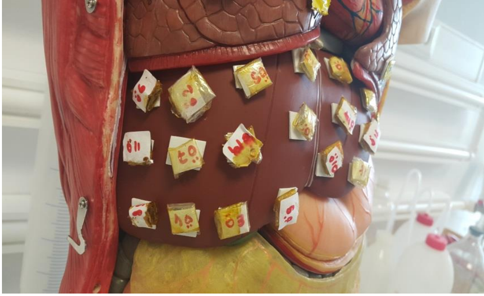
Şekil 4.6 : Cr-51 paketçiklerinin karaciğer üzerine yerleştirilmesi.
