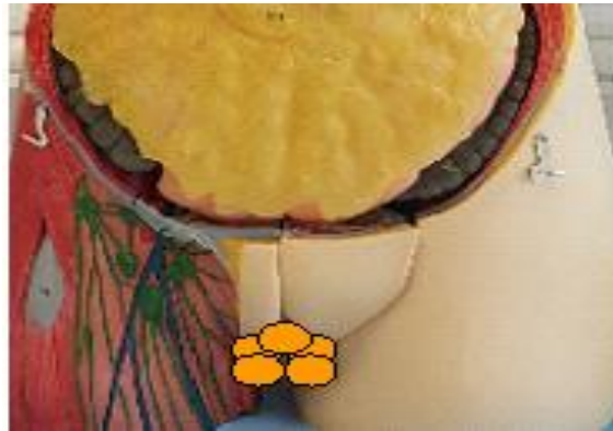
Şekil 4.14: Gonata yerleştirilen TLD’lerin pozisyonlaması.
