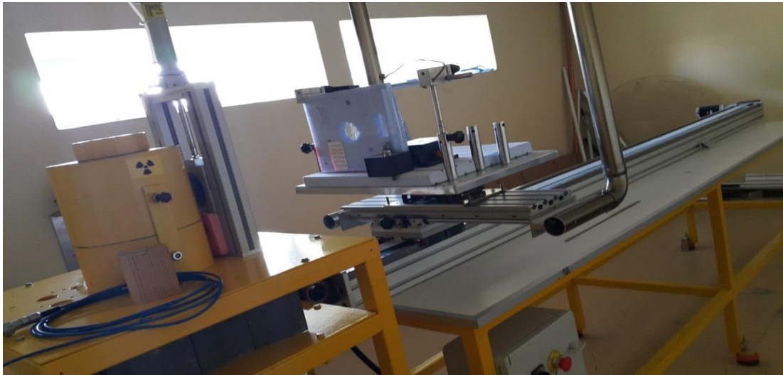
Şekil 4.21: TLD 'nin kalibrasyonları için Cs-137 kaynağı tarafından ışınlanması.
