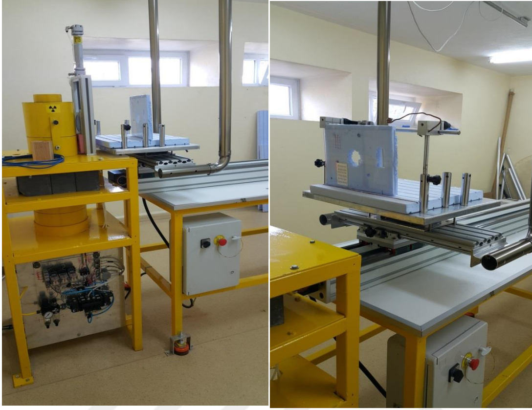
Şekil 4.20: Cs-137 kaynağı ve TLD'lerin yerleştirildiği aparat.
