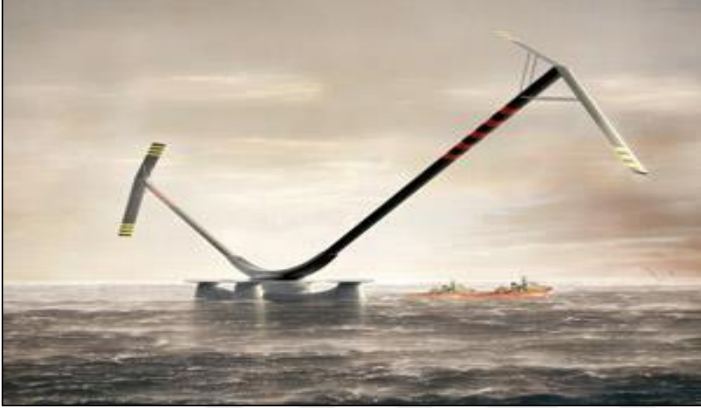
Şekil 3.9 : Eğik Eksenli Rüzgar Türbin Tasarımı.
