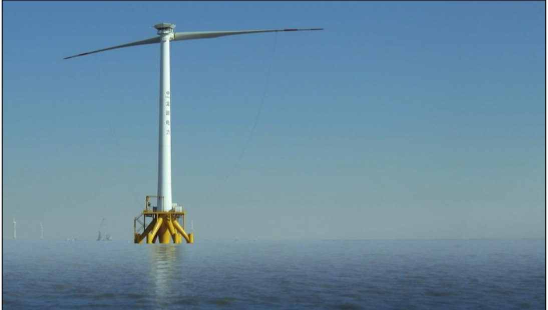
Şekil 3.11 : Çinli MingYang Firmasının 6.5 MW Gücündeki İki Kanatlı Rüzgar Türbini.
