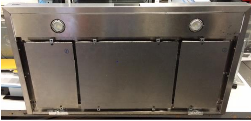
Şekil 7.26: X3:15mm ve X5:380mm perimetral boyutlarına sahip prototip.
