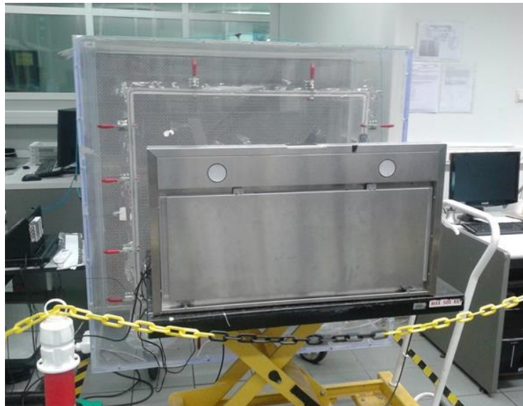
Şekil 5.4: Tek parça perimetralli prototipin rüzgar tünelineki testleri.
