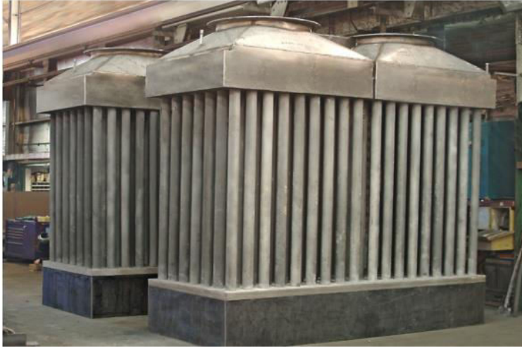
Şekil 1.10: Kanal tipi reküperatörün montajı [8].
