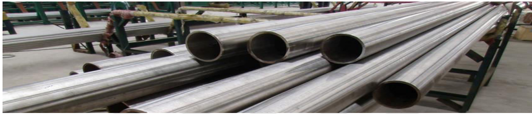
Şekil 3.1: SUS410L paslanmaz çeliğin örneği [13].
