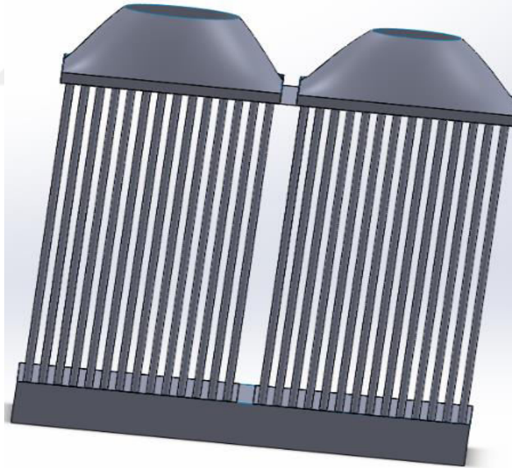
Şekil 4.10: CAD modelinde tamamlanmış reküperatör montajı.
