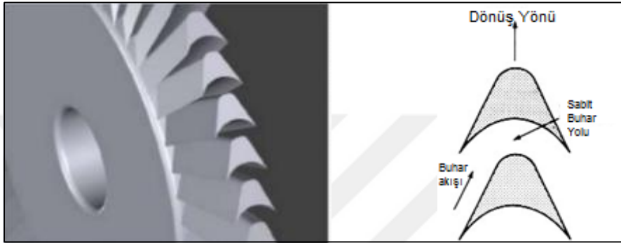
Şekil 4.3 : İmpuls türbini kanatçıkları ve kesiti [44].
