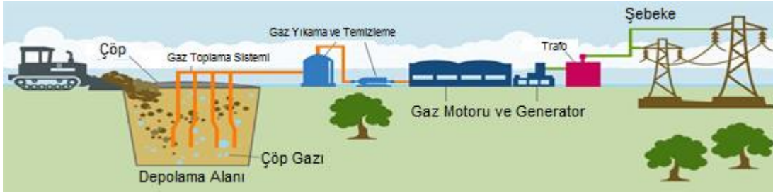
Şekil 3.8 Biyometanizasyon işlemi temel anlatımı [33].
