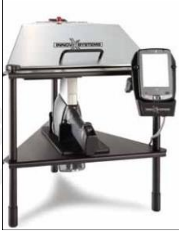
Şekil 4.6 : X-Işını floresans spektrometresi.
