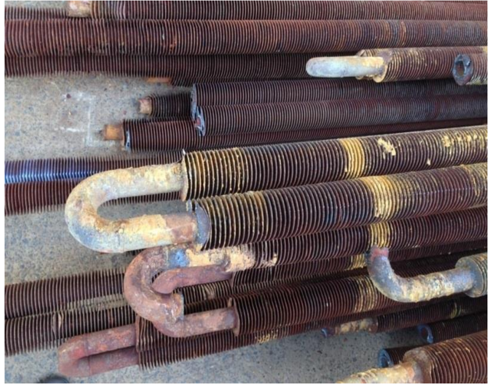
Şekil 6.12 :Yenilenmiş atık ısı kazanı boruları.
