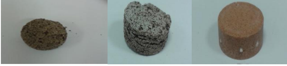
Şekil 4.1 : a) Bentonit , PbS ve Cs , b) Zeolit, PbS ve Cs, c) Zeolit, ve Cs içeren peletlerinin 600°C’de sinterlenme sonrası görünüşleri.
