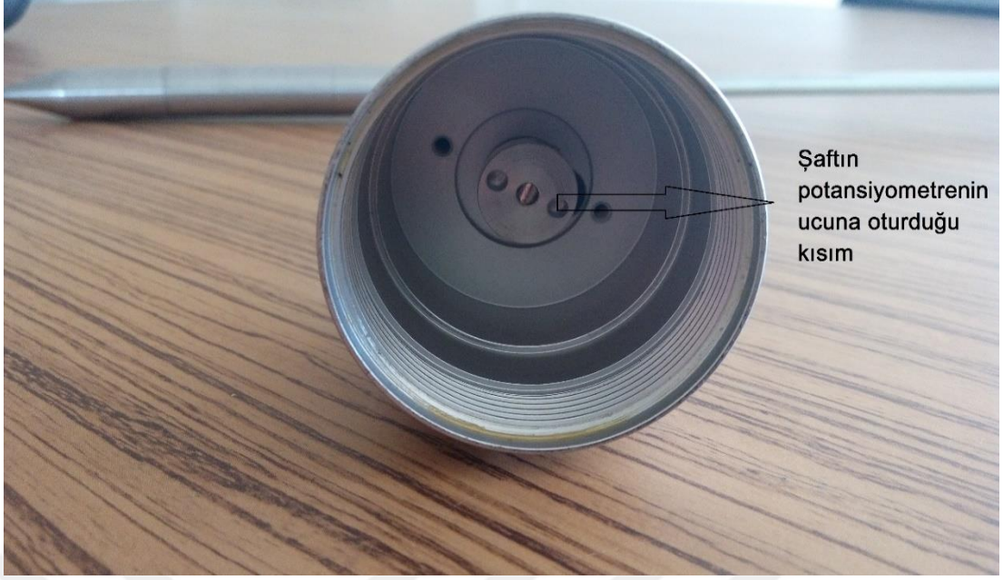
Şekil 4.14: Şaft ile potansiyometrik algılayıcıyı birbirine bağlayan yüzey.
