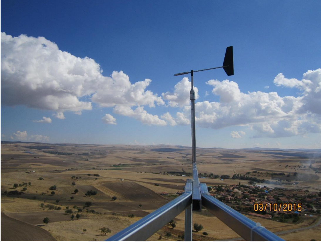
Şekil 4.23: Direk üzerinde bulunan rüzgar yön sensörü.
