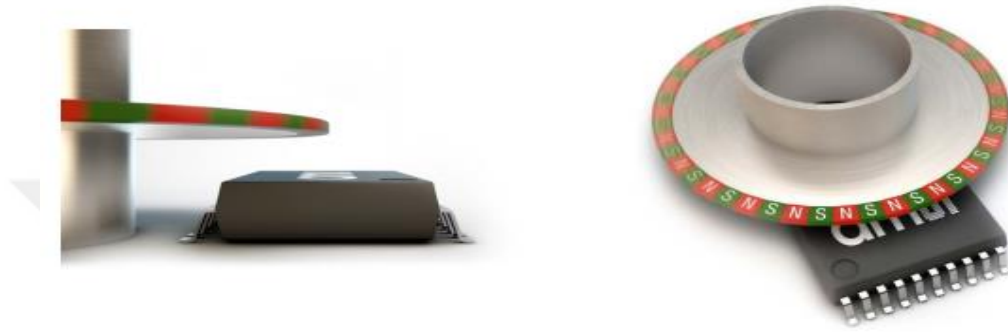
Şekil 4.7: Magnet ve Hall sensör gösterimi.
