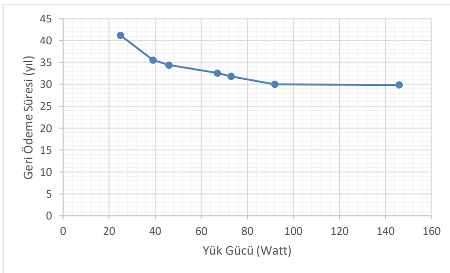
Şekil 6.9 : Mevcut durumda Gaziantep ili için geri ödeme sürelerinin yük gücüne bağlı değişimi.
