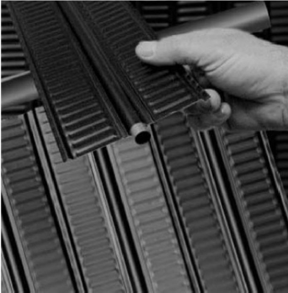
Şekil 1.24 : Boru kanatçık tipi örneği [34].
