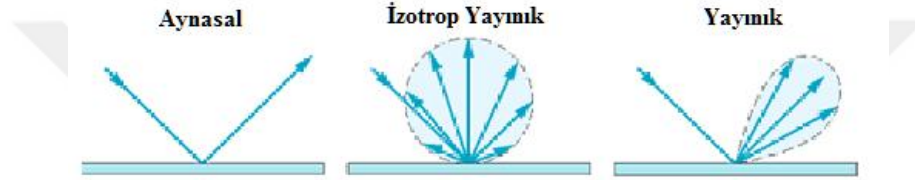
Şekil 3.2 : Aynasal, izotrop yayıncı ve yayıncı yansımalar.
