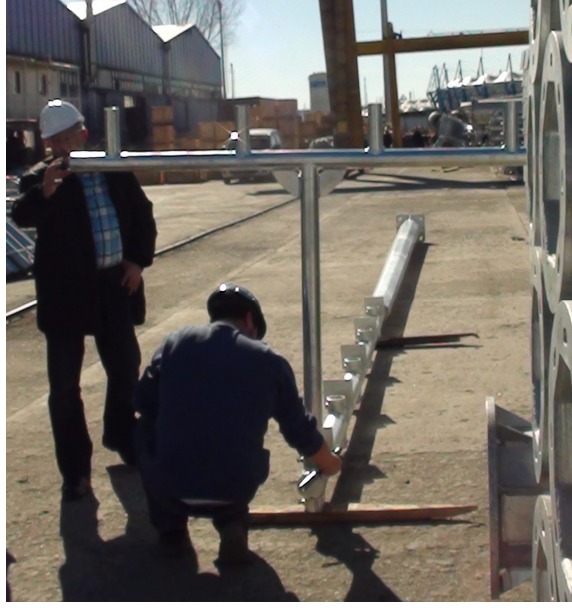
Şekil 2.2 : Direk numunesinin fabrikada kontrolü.
