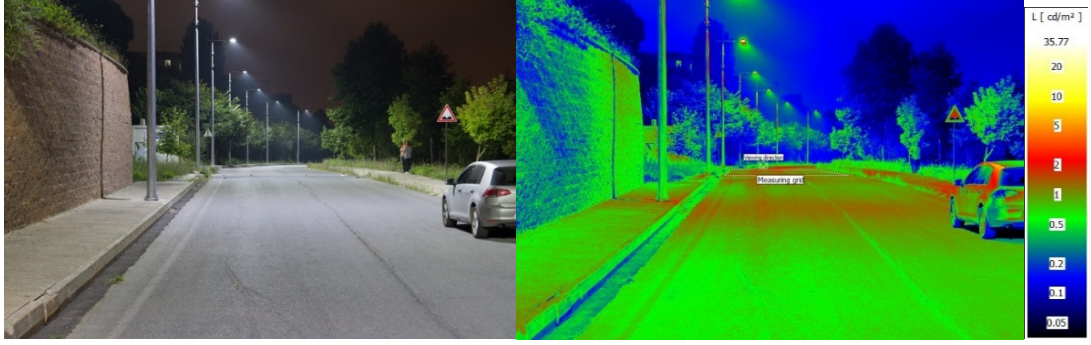
Şekil 2.9 : Test yolu ve kameralı parıltı ölçer fotoğrafı.
