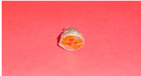
Şekil 4.1 : Deneylerde kullanılan Cs-137 gama radyoizotop kaynağı.
