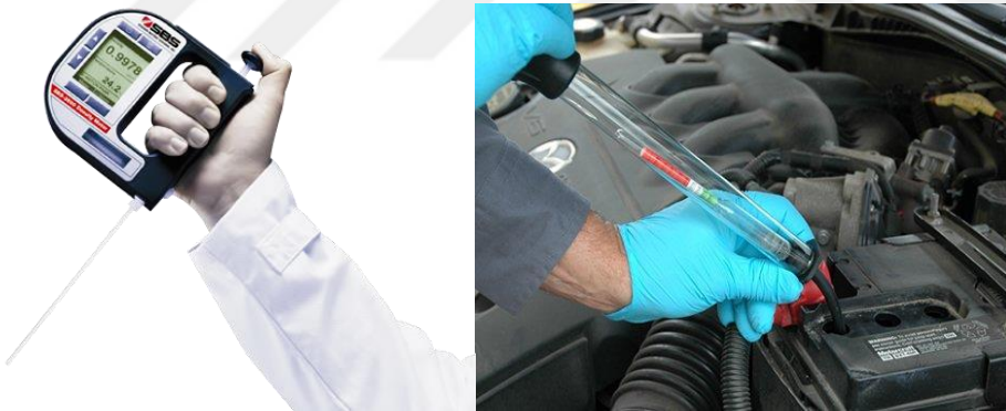
Şekil 1.4 : Kurşun asit akü elektrolit yoğunluk ölçüm cihazları [5]
