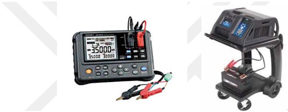
Şekil 1.5 : İç direnç ölçüm cihazları [6],[7].
