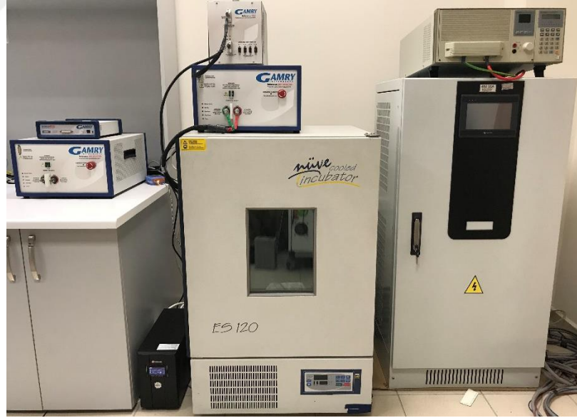
Şekil 3.1 : Empedans analizi ve batarya yaşlandırma düzeneği.
