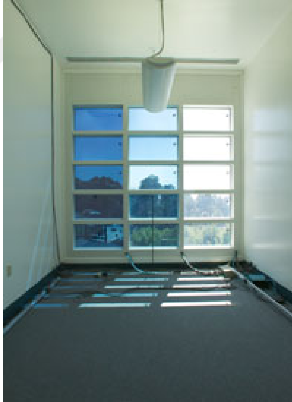
Şekil 4.7 : Elektrokromik camın sağdan sola renk değiştirme aşamalarının gözlemlenebileceği saha testleri görülmektedir.
