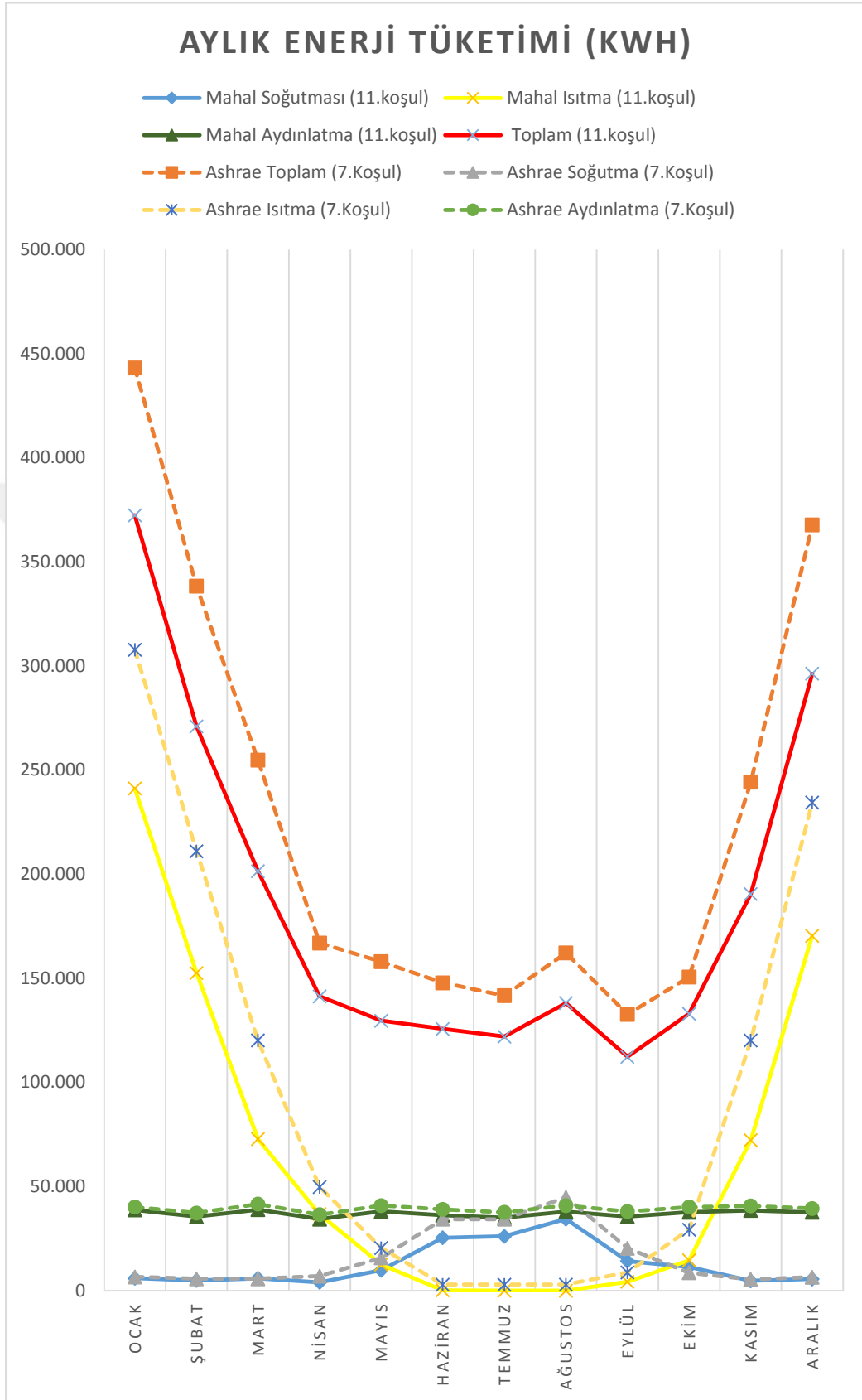
Şekil 5.15 : Kars'da elektrokromik camın 11.Koşul ve Ashrae (7.Koşul) için aylara göre enerji tüketimleri (kwh).
