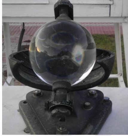
Şekil 3.11 : MGM 1.Bölge Müdürlüğü'nde kullanılan helyograf.
