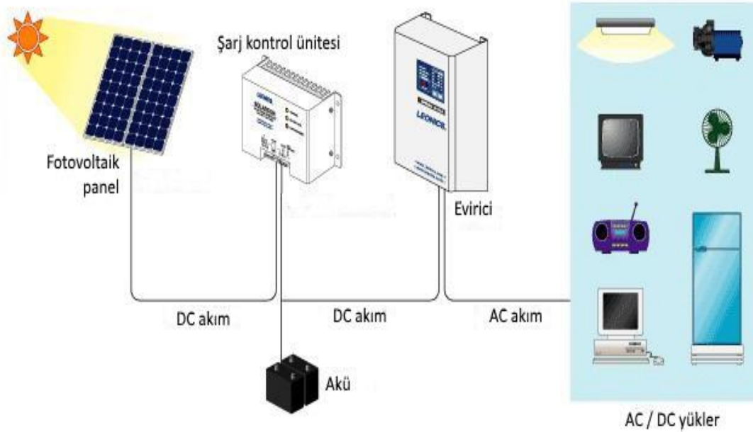
Şekil 3.14 : AC ve DC yüklerin bulunduğu bataryalı FV sistem.
