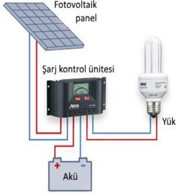
Şekil 3.13 : Şarj kontrollü bataryalı FV sistem.
