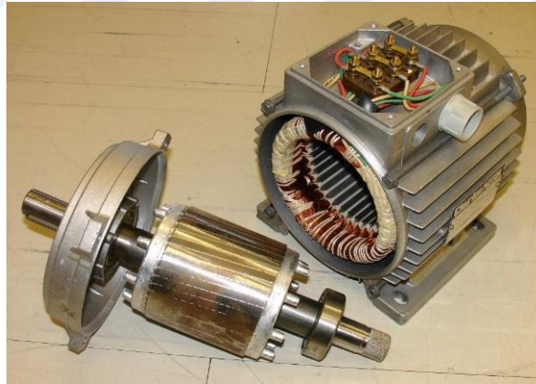
Şekil 2.9: Stator ve rotoun ayrılmış hali [24].
