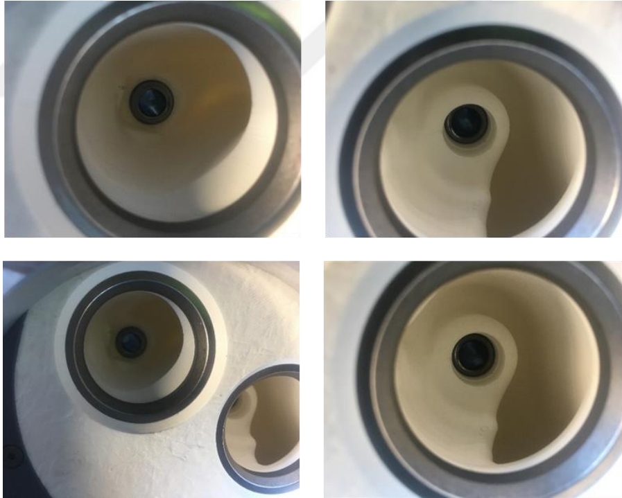
Şekil 5.19 : Plastik malzemeden yapılmış prototip silindir kafasının endoskopik kamera görüntüleri.
