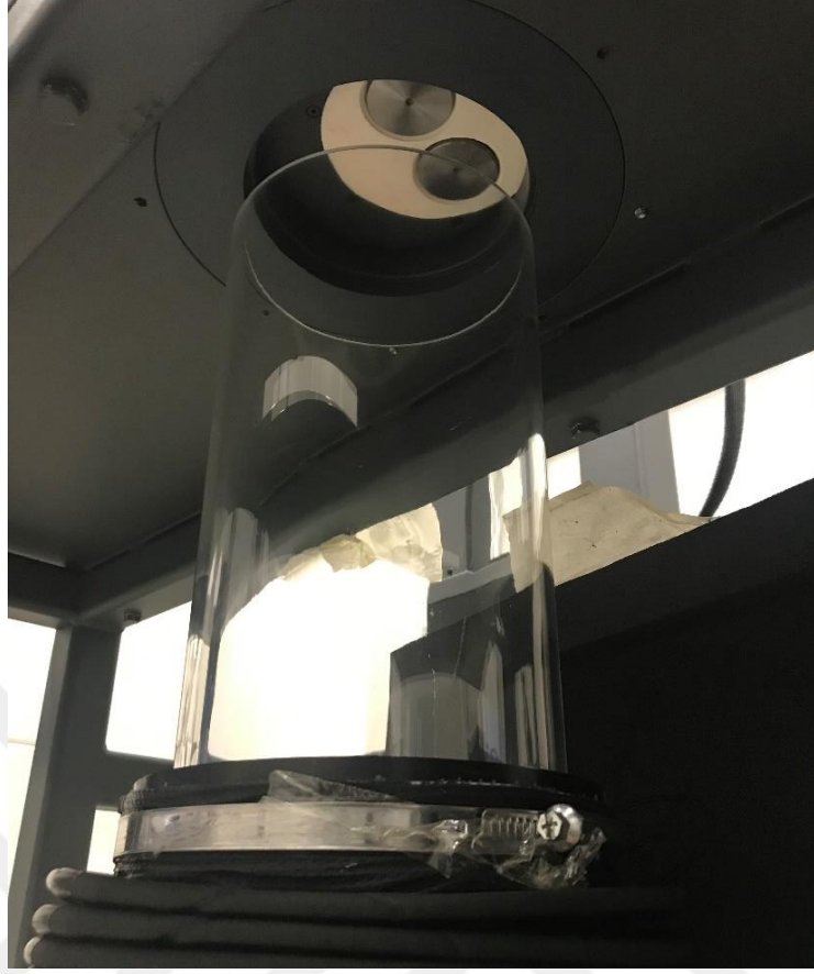
Şekil 3.8 : Ford Otosan'daki optik motor silindiri.
