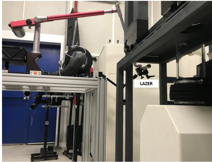
Şekil 3.9 : Ford Otosan'daki lazer düzlemi oluşturma düzeneği.
