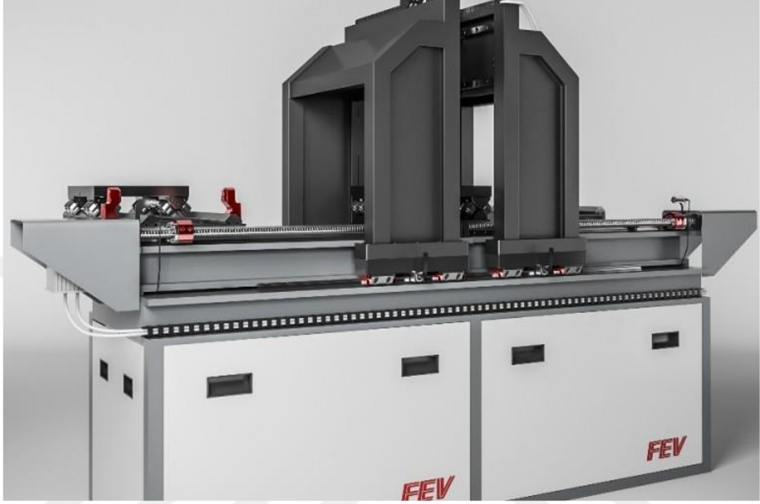
Şekil 3.11 : Ford Otosan girdap oranı ölçümü düzeneği.
