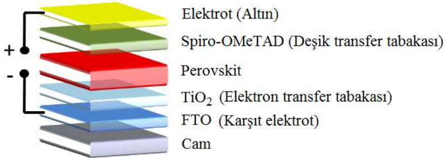
Şekil 2.6 : Perovskit güneş hücresinin yapısı [33].
