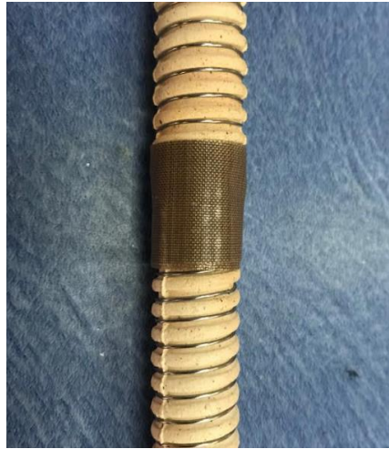
Şekil 5.16 : Rezistans seramiği ve rezistans telinin sarımı.
