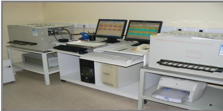
Şekil 3.18 : Berthold marka LB-770 Model gaz akışlı orantılı ölçüm sistemi.
