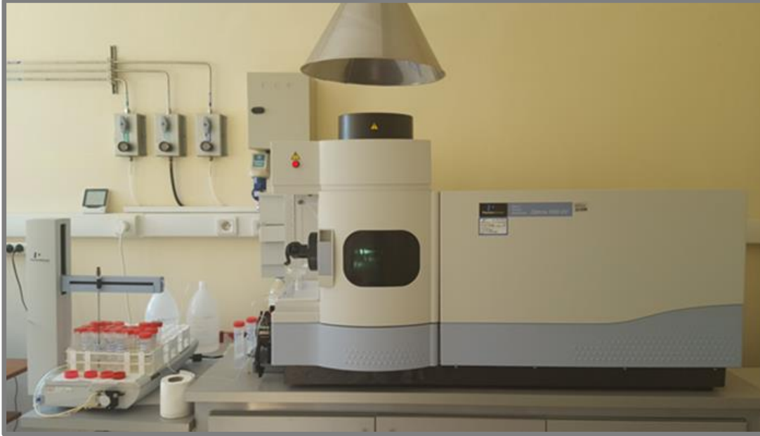
Şekil 3.20 : ICP-OES gaz akışlı orantılı ölçüm sistemi.
