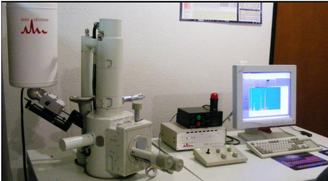
Şekil 2.10 : SEM ve bağlı EDS cihazı görüntüsü (Url-6).
