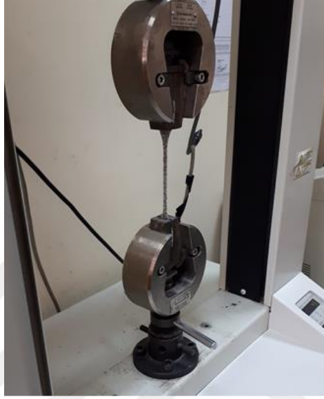
Şekil 4.21 : Esneklik testi sırasında numunenin görünümü.
