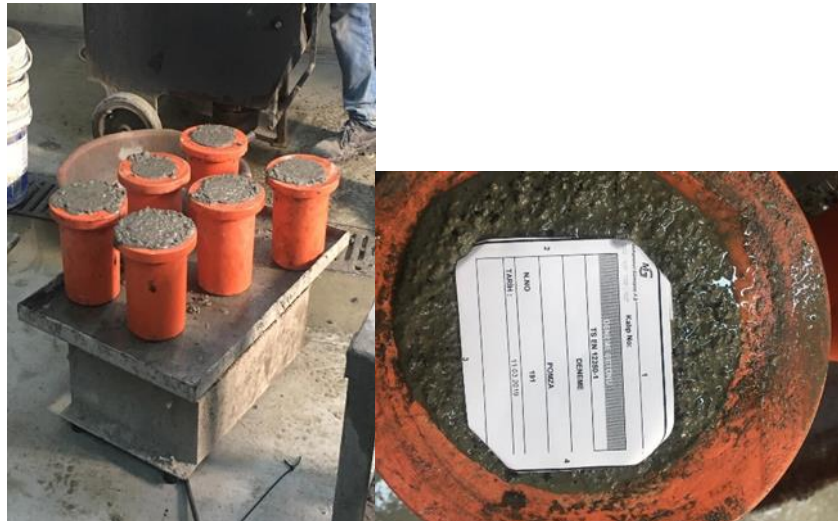
Şekil 4.3 : Taze betonun kalıplara alınması ve etiketlenmesi.
