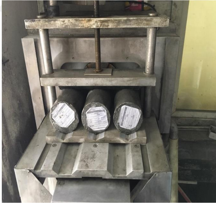
Şekil 4.5 : Beton numunelerin tıraşlama işlemi.
