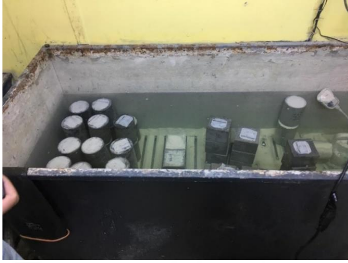
Şekil 4.4 : Beton numunelerin kür havuzunda bekletilmesi.
