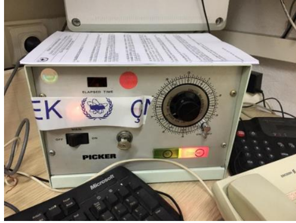
Şekil 4.12 : Co-60 kontrol ünitesi (Picker).
