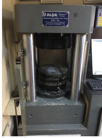
Şekil 4.6 : Beton numunelerin basınç dayanım testi.
