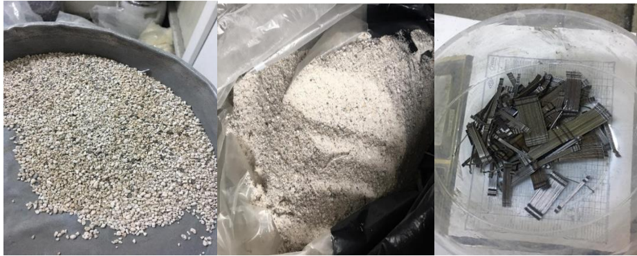
Şekil 4.1 : Özel beton üretiminde kullanılan ponza, barit ve çelik lif malzemeler.
